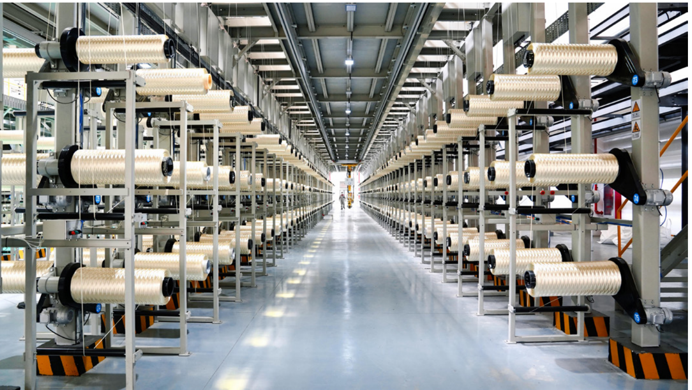
高性能碳纤维生产线 中国建材集团供图
