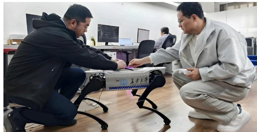
西安云合智能机器人有限公司科研人员在调试防爆四足巡检机器人
