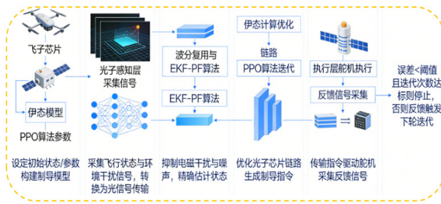
图 6 光子芯片自进化制导算法整体执行流程图
