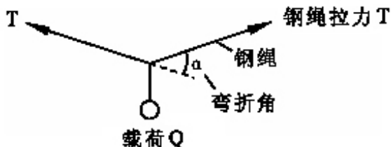
图 1 钢丝绳弯折角示意图
