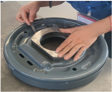
图 2 制动器安装面平面度检测
