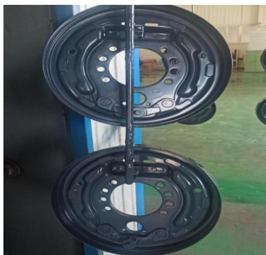
图7 底板总成高温喷粉过程
