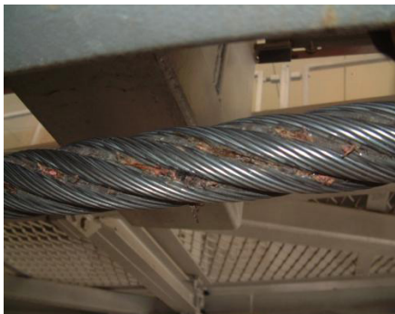
图 4 尼龙纤维绳芯断裂挤出
