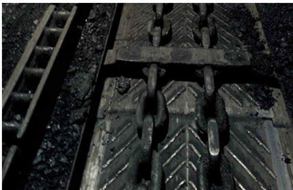
图1 刮板输送机输磨磨损与腐蚀图
